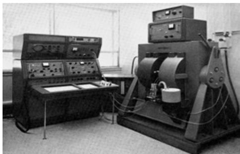
**Figura 4.10.** Espectrómetro RMN Varian HA-100 (equipamento existente no Departamento de Química da Faculdade de Ciências e Tecnologia da Universidade de Coimbra).
