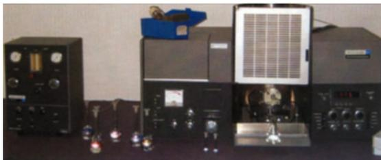
**Figura 4.8.** Espectrofotómetro de absorção atómica modelo Perkin-Elmer 403 (equipamento existente no Departamento de Química da Faculdade de Ciências e Tecnologia da Universidade de Coimbra).
