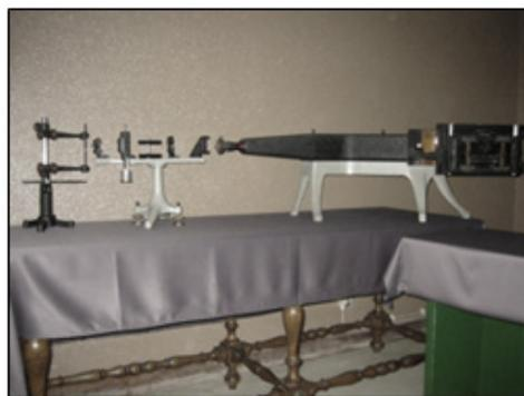
**Figura 4.4.** Espectrógrafo Hilger E316 com fotómetro Spekker H237 (equipamentos existentes no Departamento de Química da Faculdade de Ciências e Tecnologia da Universidade de Coimbra).
