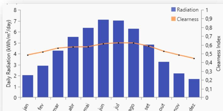
Figura 5.4 Radiação média diária em kWh/m<sup>2</sup>/dia, de cada mês do ano e índice médio de nitidez.
