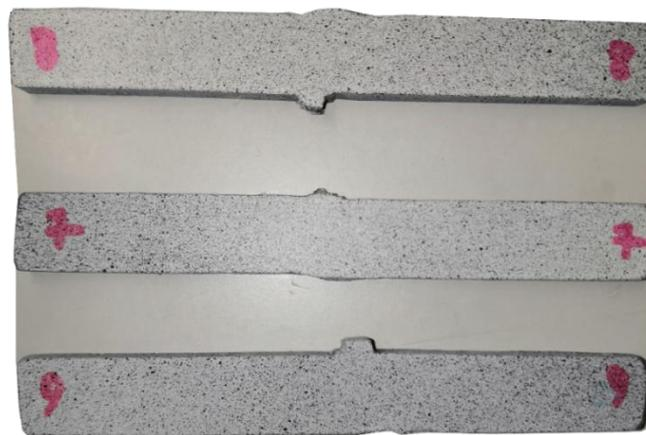
Figura AA. 3. Provetes de soldadura em aço S 460.
