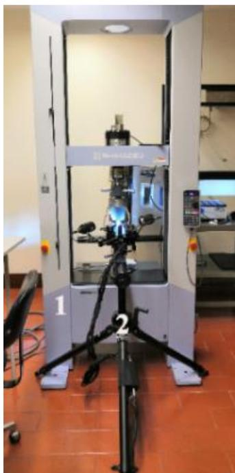
**Figura 3.5.** Sistema de ensaio de tração utilizado. 1) Máquina de tração SHIMADZU AGS-100kNX; 2) Extensómetro ótico ARAMIS Optical 3D Deformation & Strain measurement system.
