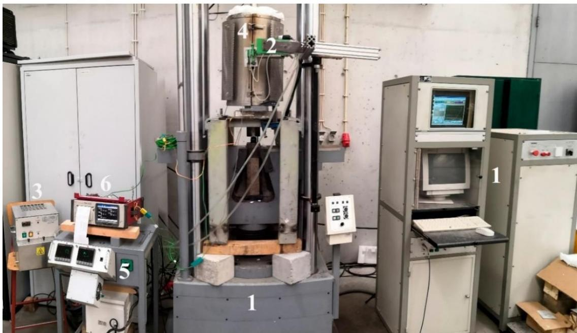
**Figura AB. 1.** Plano geral do equipamento utilizado no ensaio transiente. 1) Máquina de tração Servosis-MCH 2000; 2) Extensômetro de alta temperatura Epsilon Model 3548HI; 3) Sistema de refrigeração Epsilon Caron 2050 model; 4) Forno elétrico cilíndrico Termolab; 5) Controlador Eurotherm Controller; 6) Data logger TDS 530.
