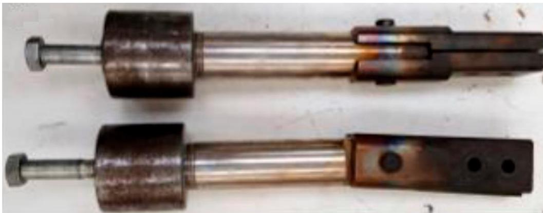
**Figura AB. 5.** Garras utilizadas nos ensaios transientes.
