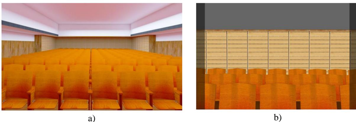
Figura 3.15 – Imagem renderizada da Solução Fixa e Solução 1 ao ser instalada no Anfiteatro AFD3.1. a) Painel com solução instalada na sala b) Imagem ampliada da solução.
