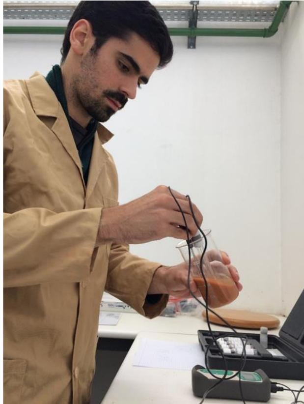
Figura 3.4 – Medição do valor do pH do solo A25/S75 em laboratório.
