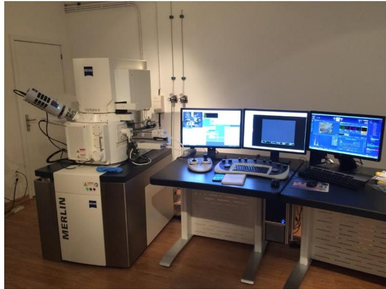
Figura 4.9 – Equipamento utilizado na realização do ensaio SEM.
