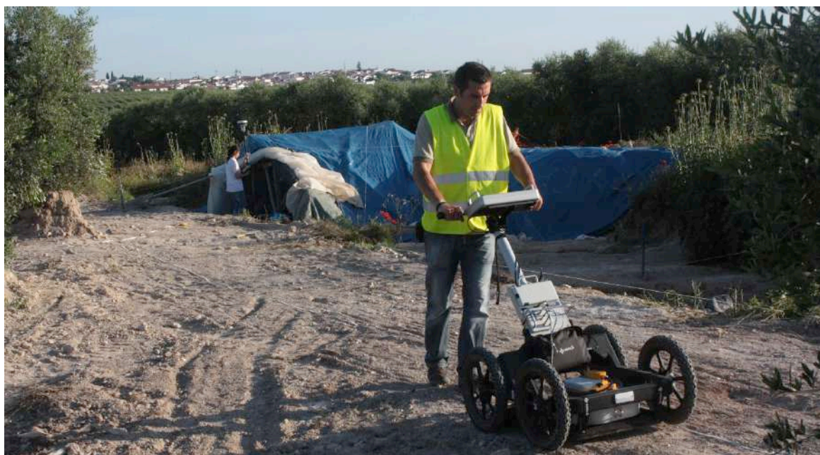
Fig. 2.10 – Prospecção geofísica (com utilização de um geo-radar) no Monte do Carrascal 2.
