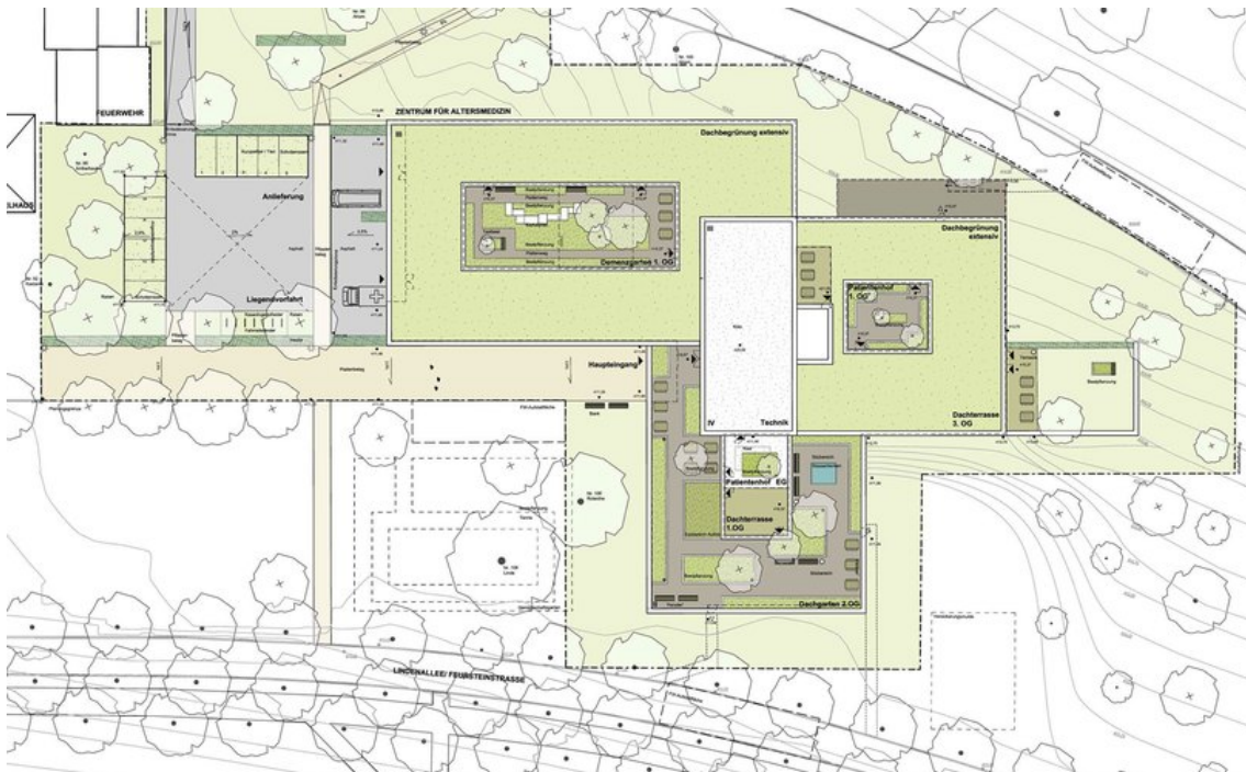
Figura 48. Planta de Cobertura do Centro Psiquiátrico Reichenau, onde se pode perceber a cobertura acessível, o terraço jardim e os inúmeros pátios distribuídos por todo o edifício, para além disso, por jogar com o desnível do terreno, o espaço exterior é acessível a partir dos dois pisos.
