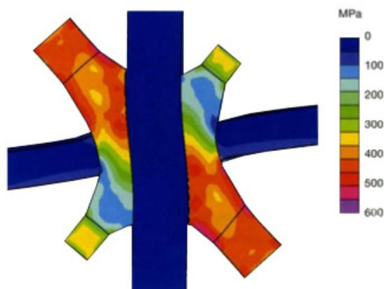
Fig. 68 Análise de Cargas nas Intersecções entre os Elementos da Grelha.
