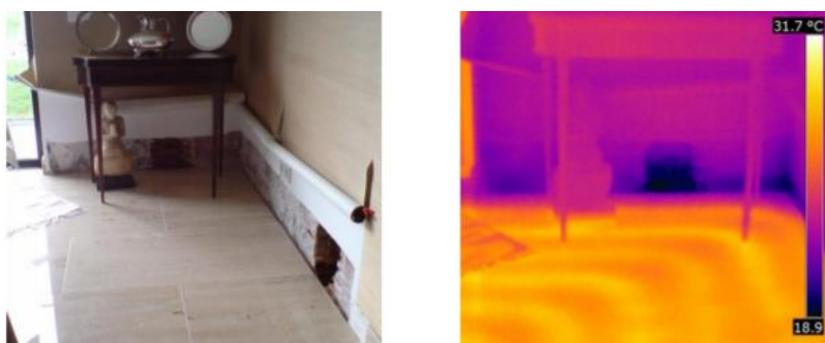
Figura 3.14 - Visualização do traçado da rede de um pavimento radiante, num termograma (Mendonça et al., 2013).
