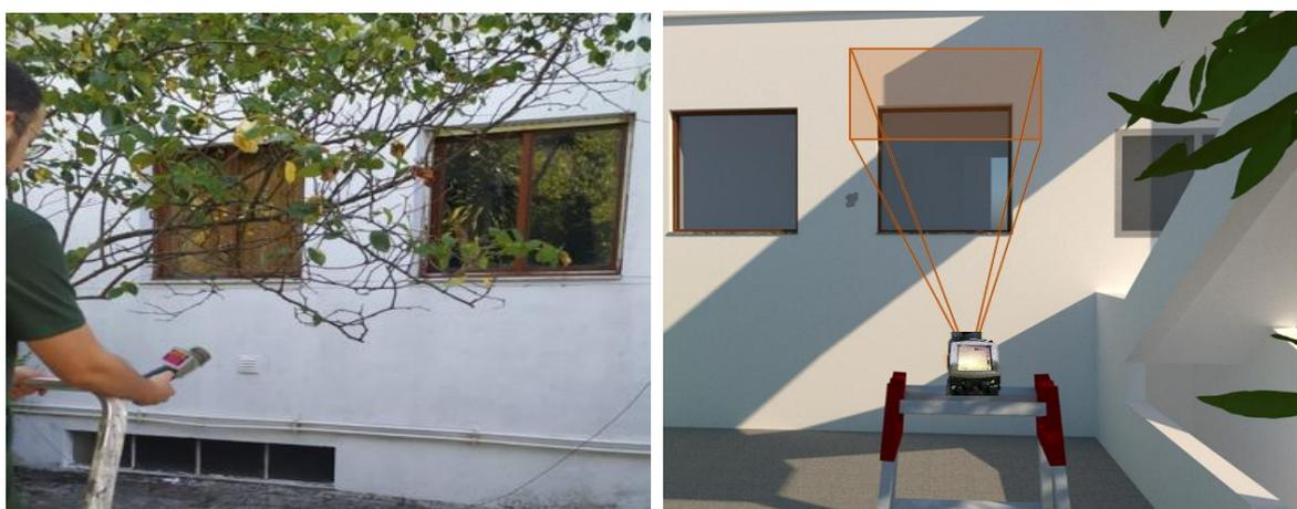
Figura 4.13 - a) Posição de captura de termogramas pelo exterior; b) Esquemática da área em estudo captada pela câmara termográfica.
