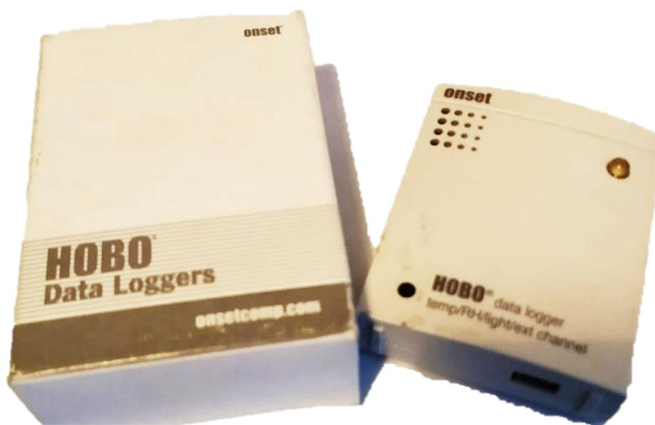
Figura 4.8 - Sensores portáteis de temperatura ambiente e humidade relativa, *HOBO U12-012*.
