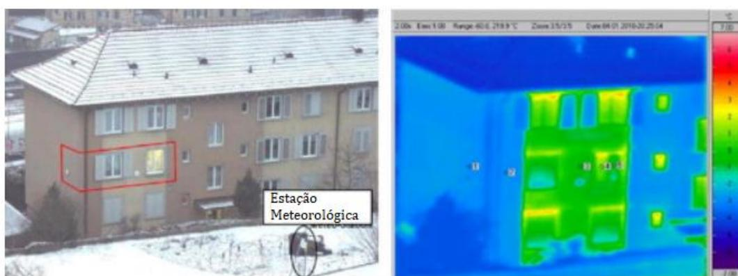
Figura 3.6 - Vista de um edifício em Winterthur, Suíça, e respetivo termograma durante a estação de aquecimento, evidenciando (a verde) as quebras de isolamento na fachada (adaptado de Lehman et al., 2013).
