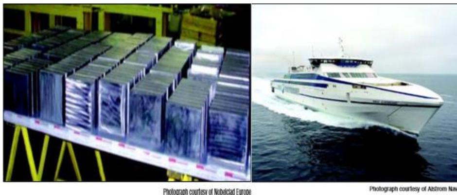
**Figura 2.1.** Ligação bimetálica usada em fábrica de fundição de alumínio, e lancha de alta velocidade construída a partir de ligação de metais dissimilares, (adaptado de [4]).
