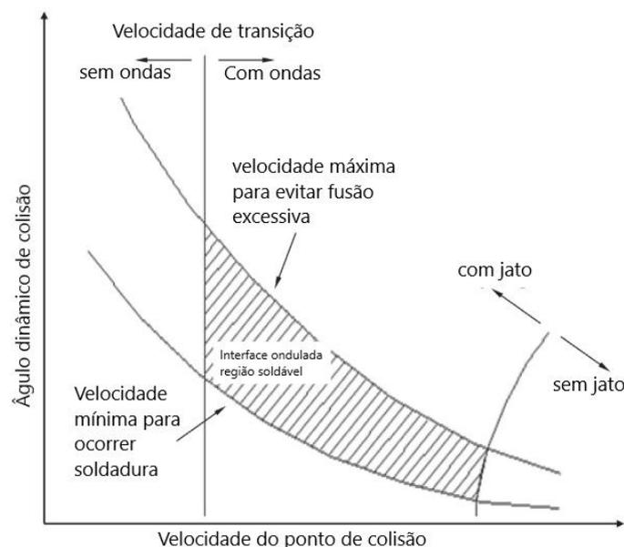
Figura 2.6. Limites da janela de soldabilidade (adaptado de [1])
