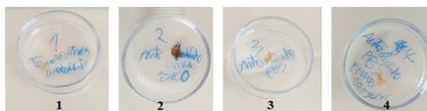
**Figura 3.9** – Fotografias de discos WD9.1 após a autoclavagem. 1- Disco não autoclavado e mantido à temperatura ambiente. 2- Disco autoclavado a seco. 3- Disco autoclavado imerso em PBS. 4- Disco autoclavado imerso numa solução de PHMB em PBS.
