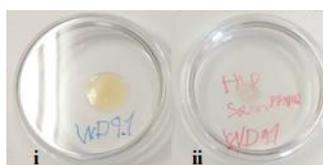
**Figura 3.3** – Discos de 2 cm de diâmetro cortados a partir dos filmes de CS obtidos com a formulação WD9.1 (i) e com a formulação WD9.1a (ii).
