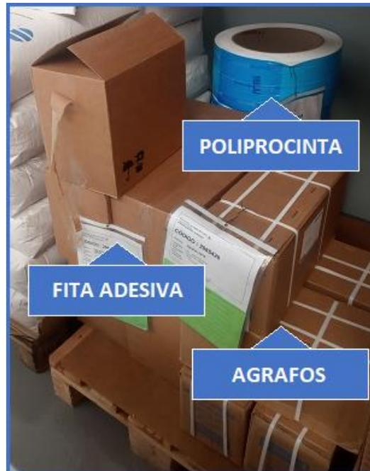
**Figura 23.** Exemplo de palete partilhada de artigos (para retirar o artigo do fundo da palete, é necessário retirar os da frente)
