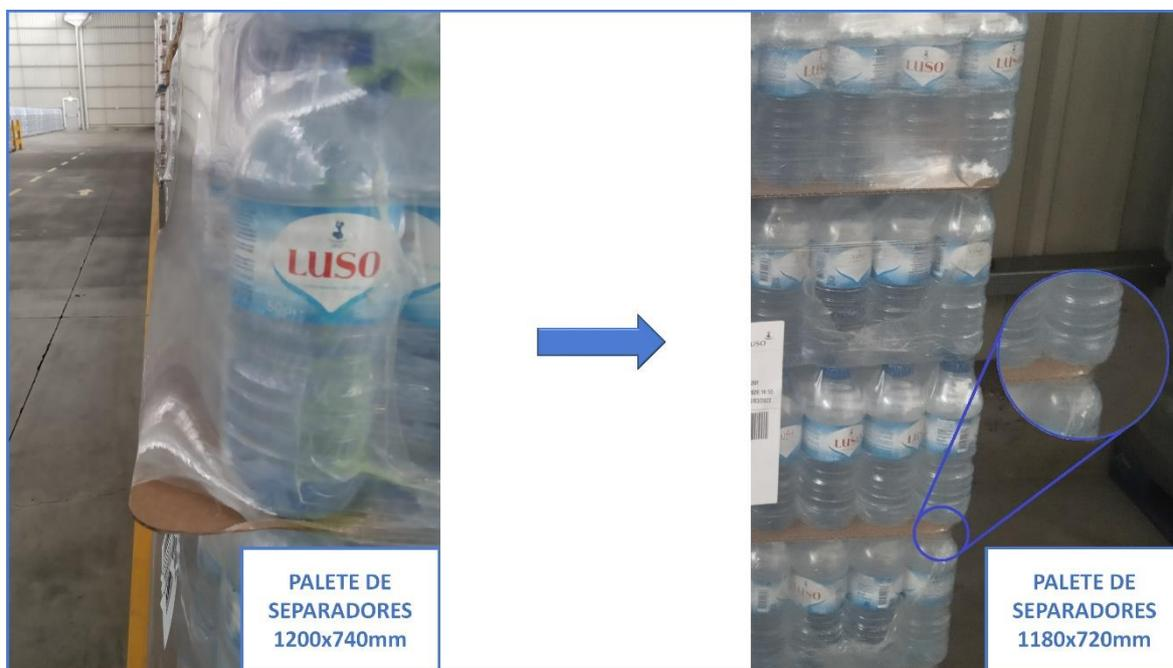
**Figura 60.** Influência das dimensões do cartão no filme envolvente
