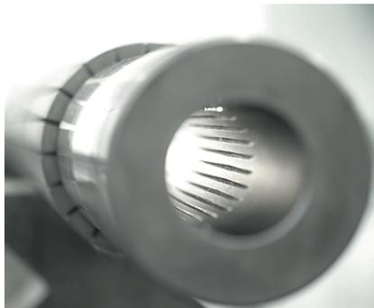
Figura 12 - Exemplo do interior de uma câmara de extrusão [44]
