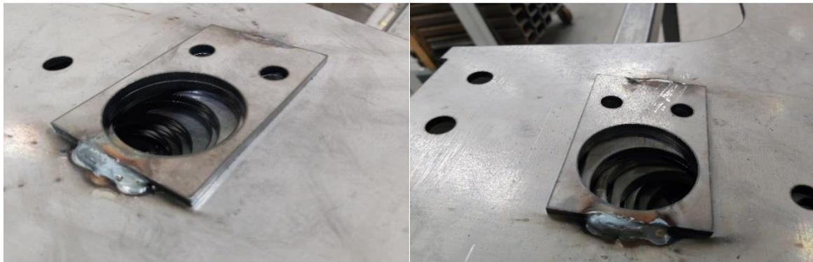
**Figura 43. Compensação do diâmetro do furo das arcadas**
