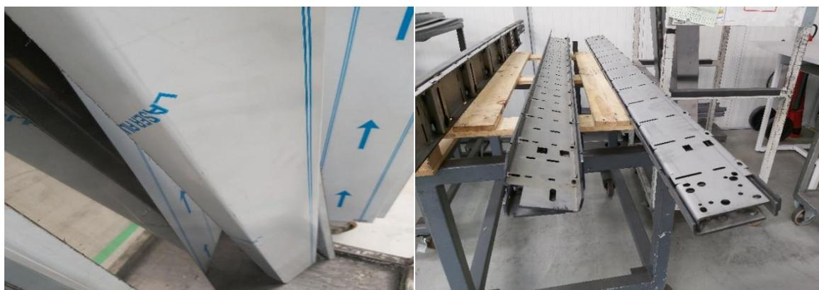
**Figura 46. Eliminação do plástico envolvente do aço inox**
