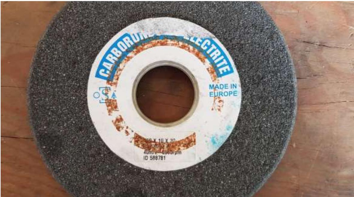
Mó utilizada na retificadora, com classificação do grão quanto à dureza de [S] (duro).
