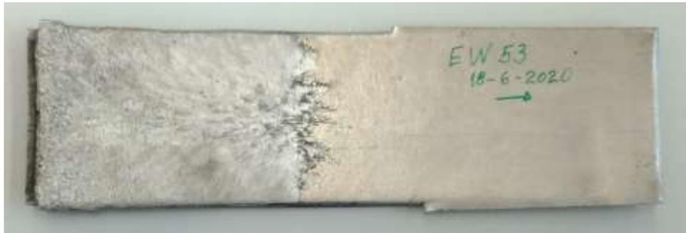
**Figura 4.10-** Materiais após o ensaio explosivo EW53.
