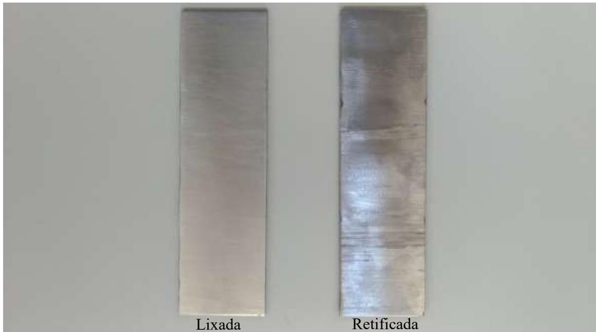
Superfícies da placa de base (AISI304) alteradas, EW53 (lixada) e EW54(retificada).
