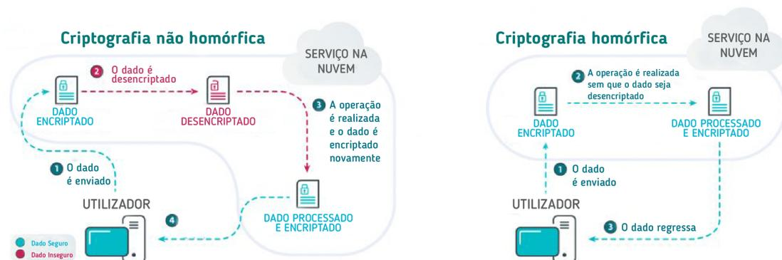
Figura 3.3: Comparação entre criptografia não homomórfica e homomórfica [29]
