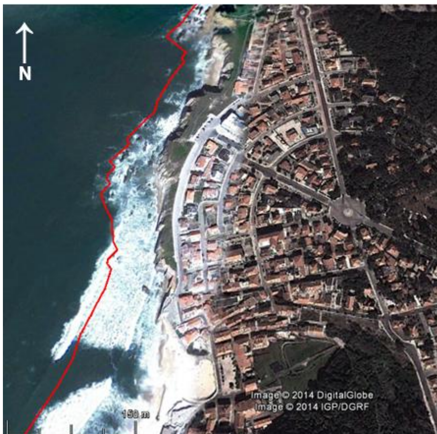
Fig. 41 - S. Pedro de Moel (imagem do Google Earth de 16/10/2009). Já não se identifica o prisma arenoso que se identificava defronte das arribas nas duas figuras anteriores.
