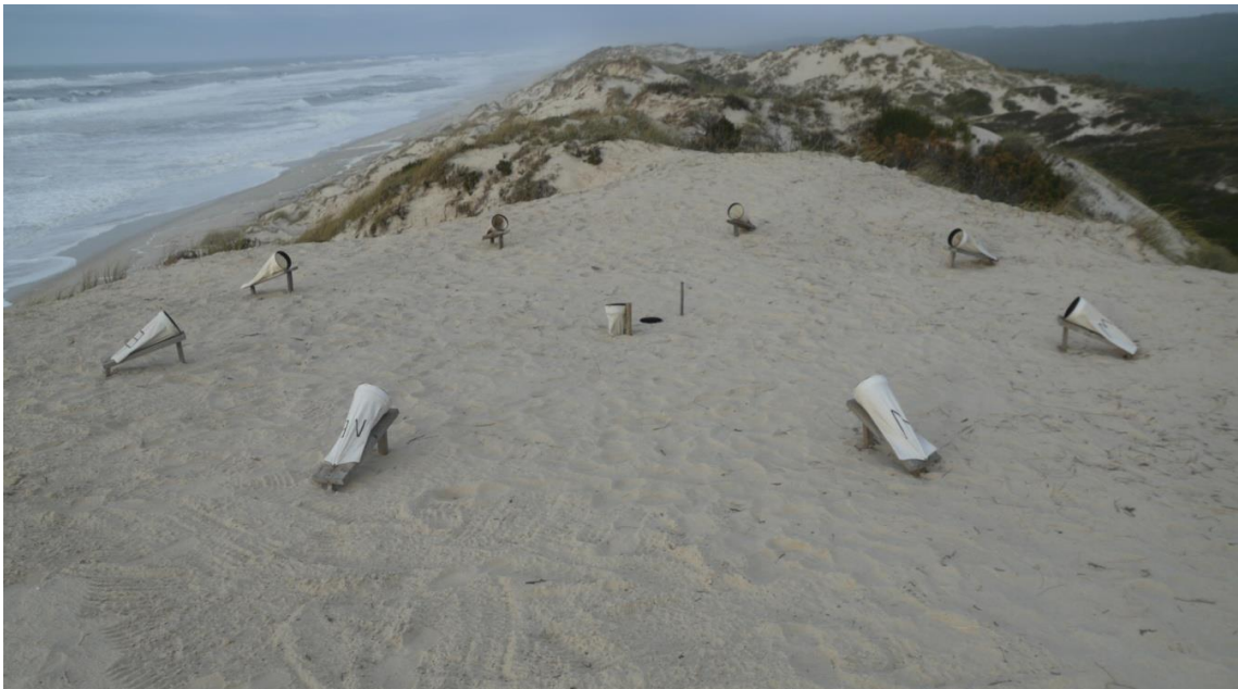
Fot. 73 - Armadilhas colocadas na crista de uma duna do cordão frontal para a quantificação do material deslocado pelo vento.
