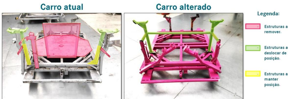
**Figura 25.** Proposta de alteração do trolley de transporte de cabine no processo de revestimento
