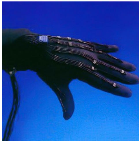
Figura 2.3 – Data Glove da VPL vestida na mão de um utilizador. 6
