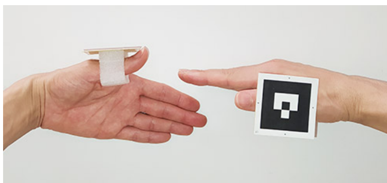
Figura 6.16 – Objetos com marcadores para representação das mãos aplicados nas mãos do utilizador
