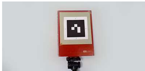
Figura 4.58 – Marcador visual impresso para rastreamento da posição do conteúdo digital.
