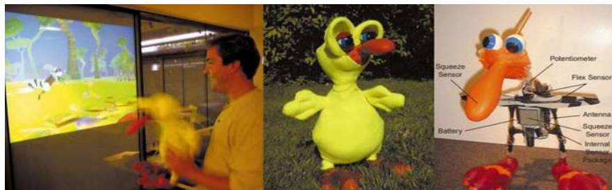
Figura 2.18 – Componentes de um sistema que utiliza um controlador visualmente familiar. 42
