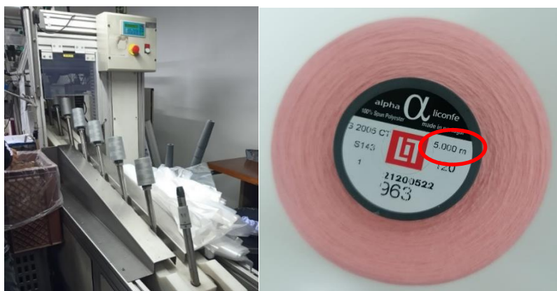
Figura 2.6. Processo de etiquetagem dos cones
