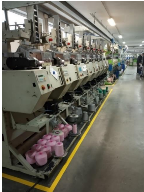
Figura 2.5. Processo de rebobinagem do fio
