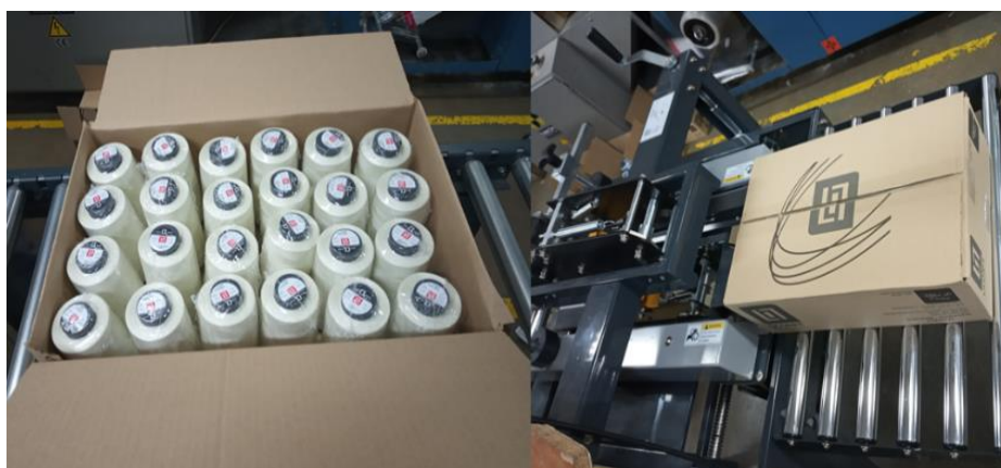
Figura 2.7. Processo de embalamento do fio
