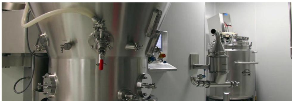
Figura 5 - Estufa de leito fluído. Adaptado de [6].
