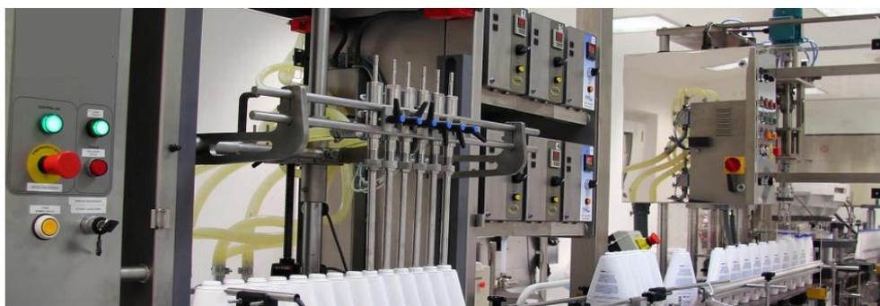
Figura 4 - Linha de enchimento de Líquidos para Uso Externo. Adaptado de [6].
