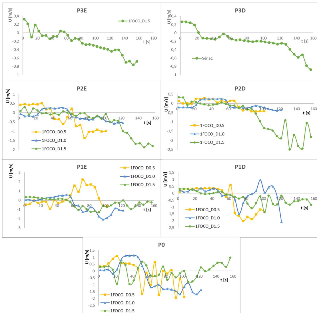
Figura 33 - Velocidade de escoamento, ensaios com um foco pontual
