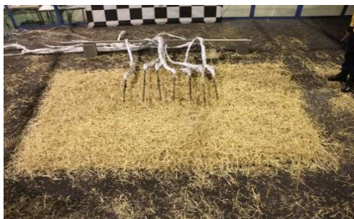
Figura 7 - Leito de combustível para ensaio
