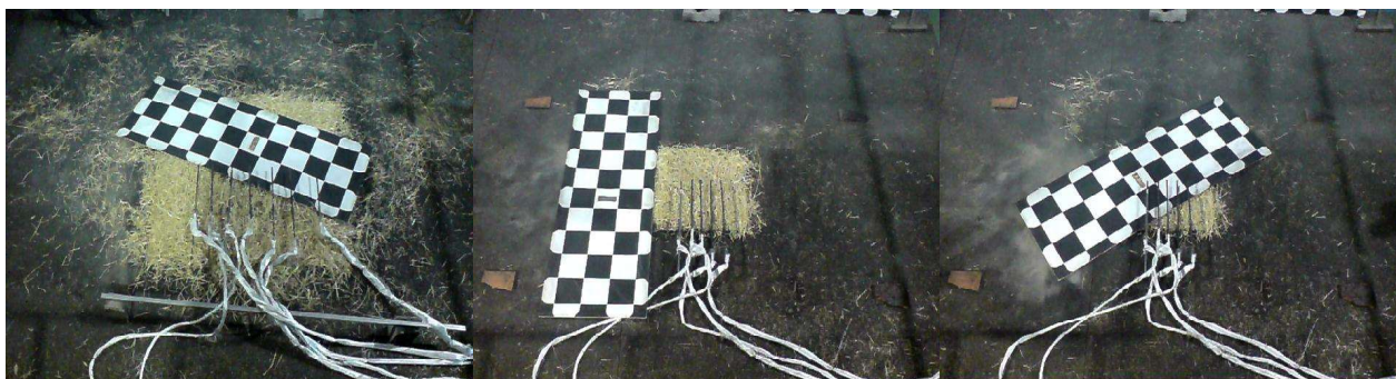
Figura 11 - Imagens utilizadas para calibração da câmara de infravermelhos
