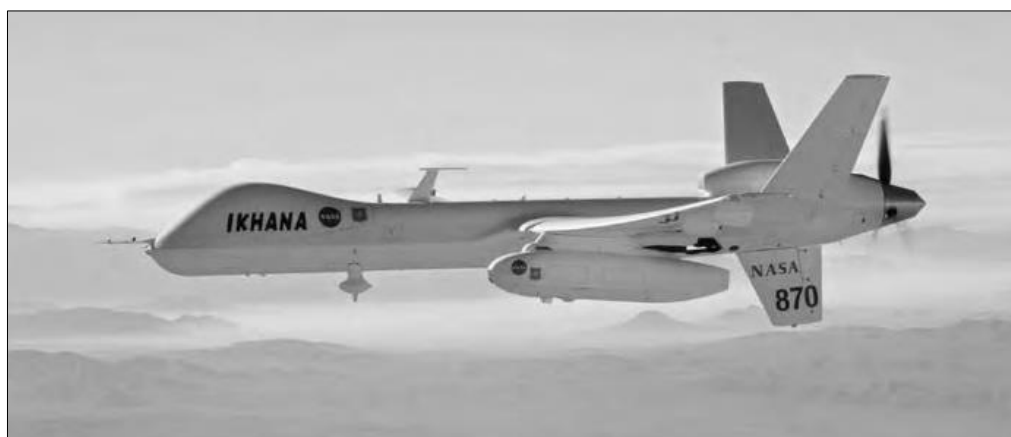
Figura 2.1: Ikhana com o sensor AMS colocado na parte inferior da asa esquerda (retirado de [17])
