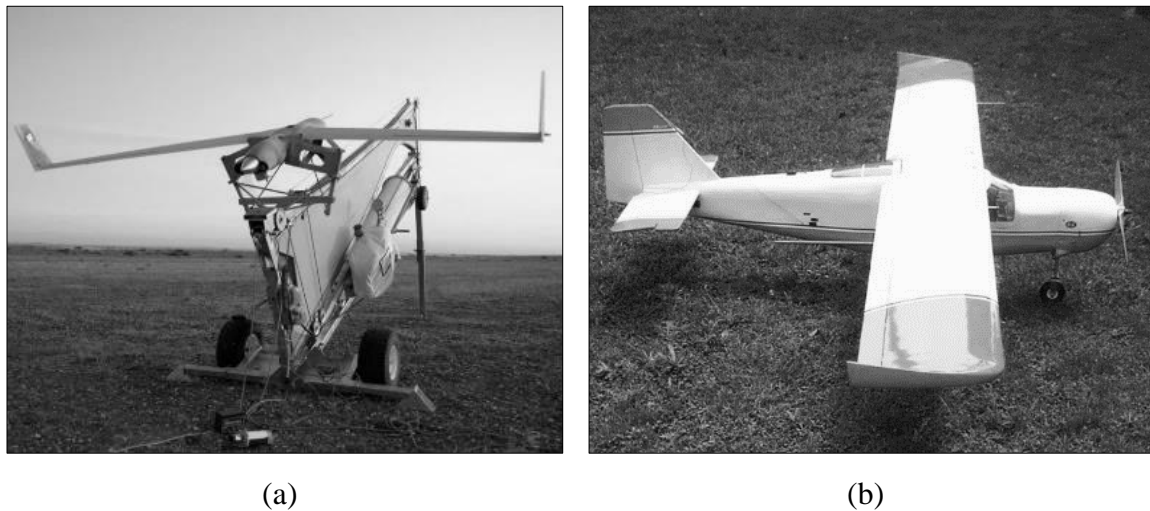
Figura 2.5: VANT de asa fixa e de perfil tático, INSITU SCAN EAGLE com equipamento auxiliar de descolagem (a) (retirado de [14]) e VANT usado no projeto “1st” – FIRST (retirado de [23]) (b)
