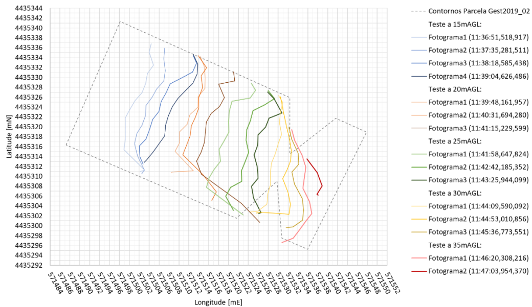
Figura G.6: Representação gráfica da frente de fogo, referenciada geograficamente, nos instantes obtidos nos patamares de altitude realizados entre 15mALG e 35mAGL, imagem de controlo, Gest2019_02
