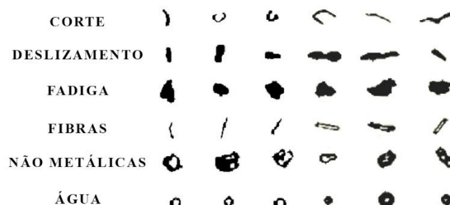
Figura 2.7. Exemplo da diversidade de partículas presentes numa amostra de óleo e sua respectiva classe (AMETEK, 2013).
