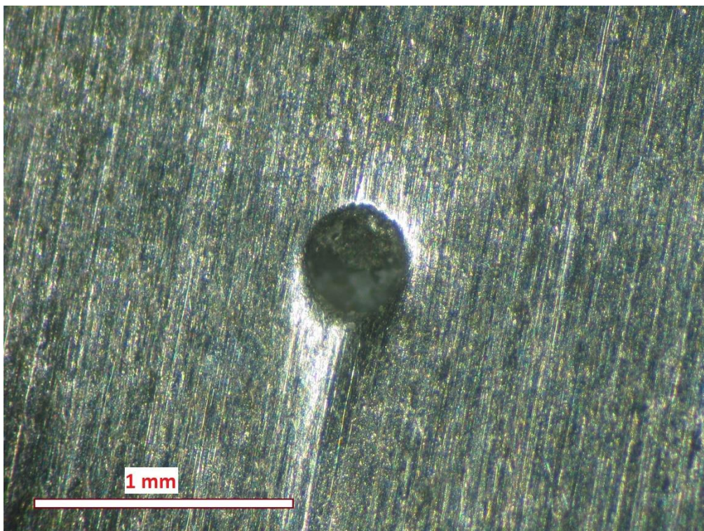
Figura D.3. Poros em revestimentos obtidos com pós reutilizados duas vezes de MetcoClad™ 6.
