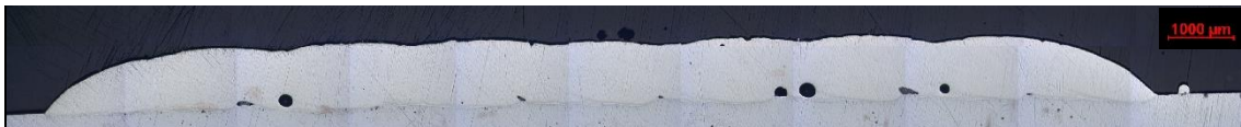
Figura 5.12. Micrografia da secção transversal de revestimentos com pós reutilizados uma vez de MetcoClad™ 6.
