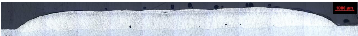
Figura A.2. Micrografia da secção transversal de revestimentos com pós reutilizados uma vez de MetcoClad™ 6.
