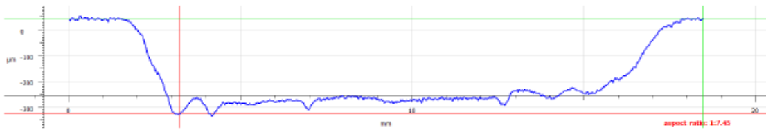
Figura 5.28. Mapa de profundidade de desgaste por abrasão de revestimentos com pós reutilizados uma vez de MetcoClad™ 6.
