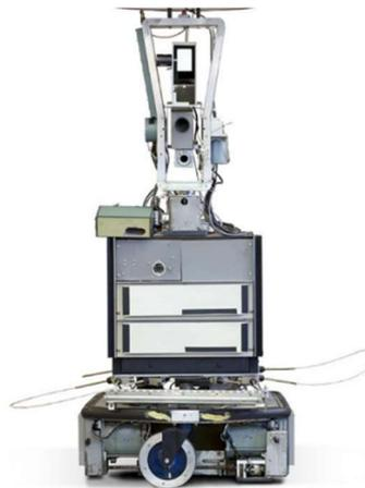
Figura 2.4 – Shakey, o primeiro robô móvel [21]
