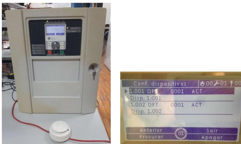
Figura 5.2 – A esquerda está o Painel GE 2X-F1 e a direita o visor do Painel a apresentar os dispositivos configurados
