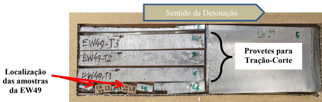
Figura 4.2. Preparação do corpo de prova EW49 para os ensaios e identificação das respetivas amostras
