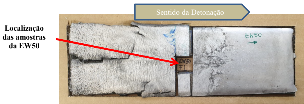
Figura 4.3. Preparação do corpo de prova EW50 para os ensaios e identificação das respetivas amostras
