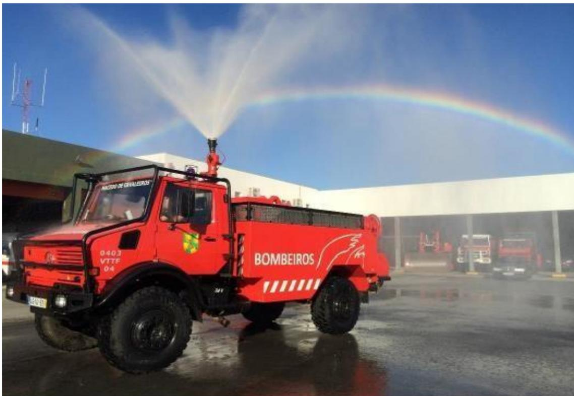
**Figura 9:** Sistema de canhão de água em VTTF do CB de Macedo de Cavaleiros (Foto: CEIF/ADAI)
