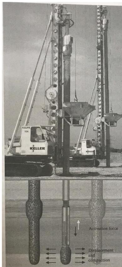
Figura 22 – Esquema de uma técnica de vibração.
