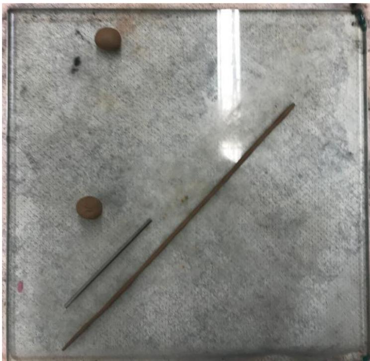
Figura 11 - Ensaio de limite de plasticidade.
