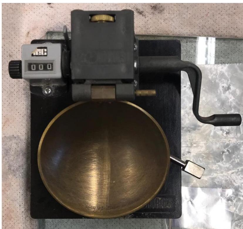
*Figura 10 - Aparelho de Casagrande do laboratório IPNLabGeo.*
