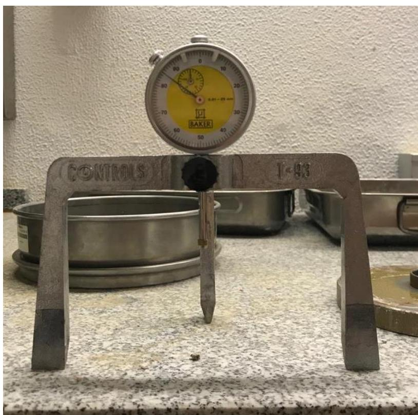
Figura 15 - Deflectômetro do laboratório do IPNLabGeo.
