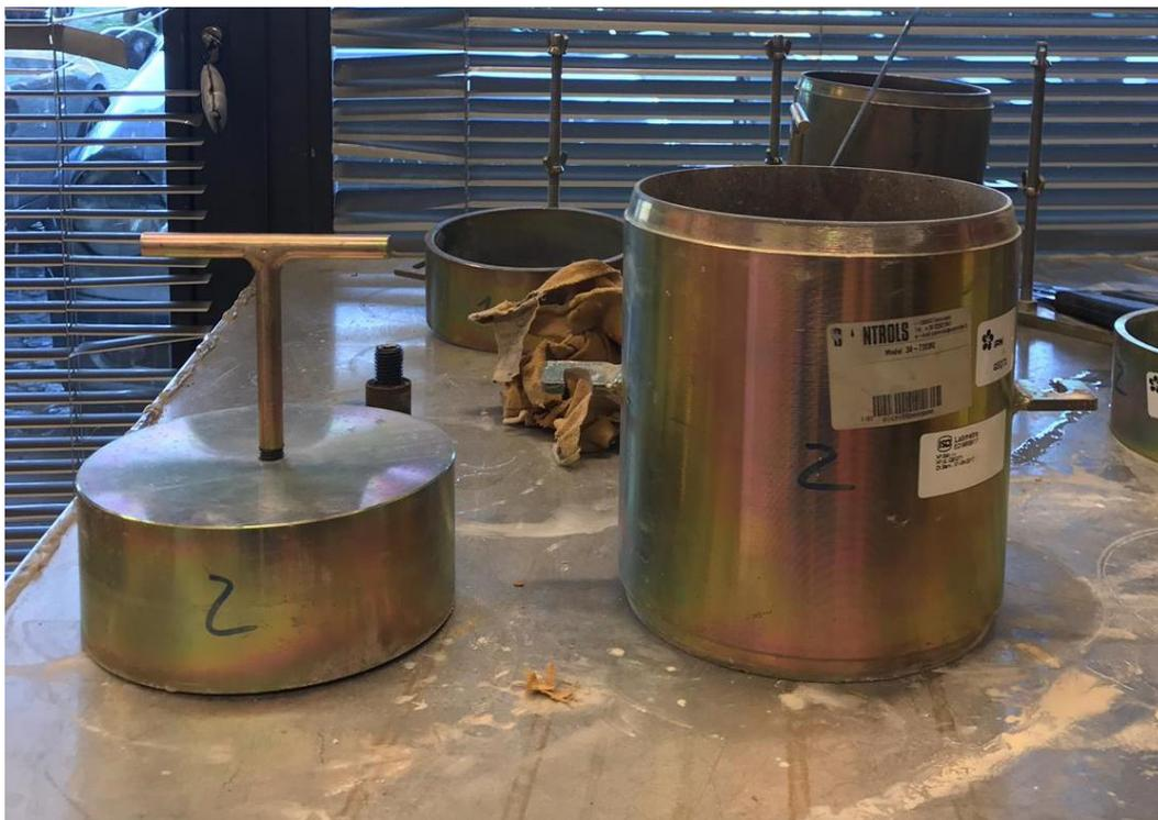
Figura 36 – Molde grande para realização do ensaio CBR.
