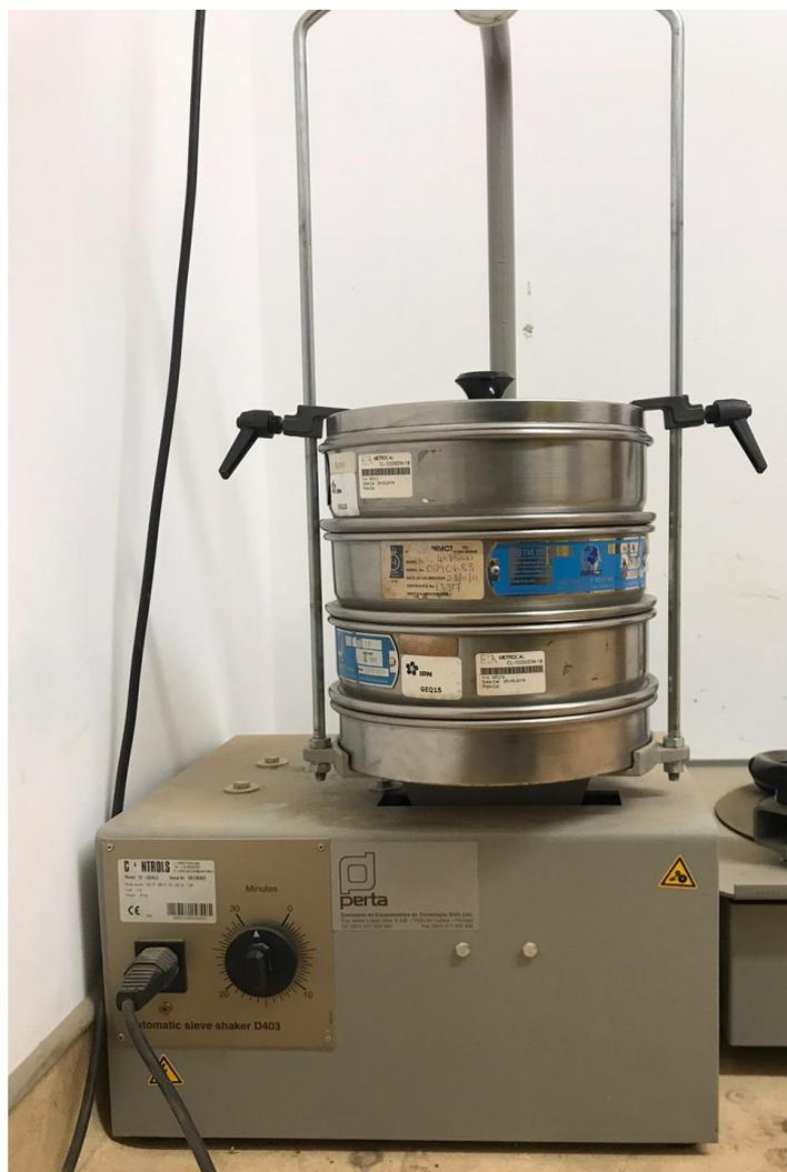
*Figura 31 – Agitador utilizado para a classificação granulométrica.*
