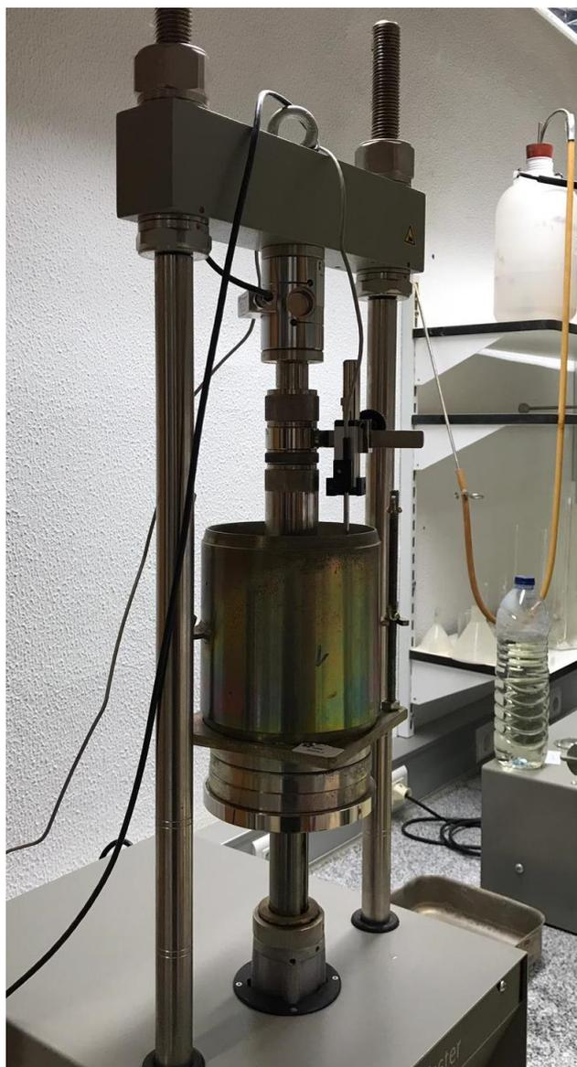
Figura 37 – Molde no equipamento para realizar ensaio de penetração.
