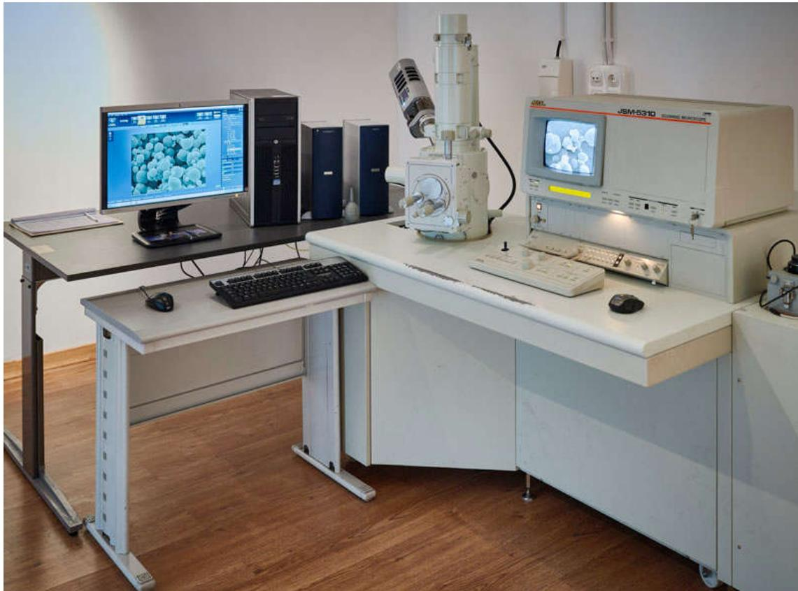
**Figura 3.10.** Microscópio eletrónico de varrimento JBM-5310.
