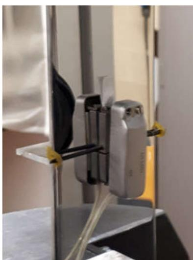
Figura 3.7. Fixação do extensómetro no provete.
