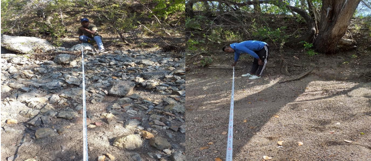
Figura 33- Medição da secção transversal do canal menor do rio Curoca em Malutuvo.
