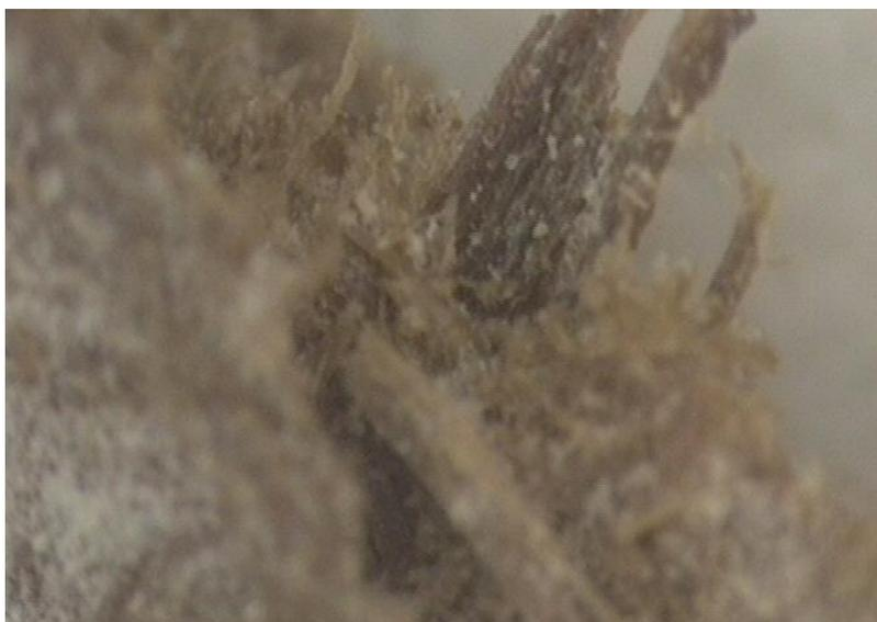
**Figura 16:** Imagem de lupa binocular digital ampliada 50 vezes onde se observa a presença de fungos no perfil do cartão da pasta superior. – Foto da autora
