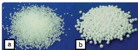
Figura 4.8 – Grãos de poliestireno: a) antes do processo de expansão; b) após o processo de expansão (Insulation Corporation of America, 2020).
