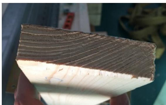
Figura 4.6 - Esmagamento na perna do provete 3-SA-C
