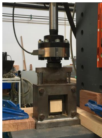
Figura 3.6 - Setup de ensaio de resistência ao corte
