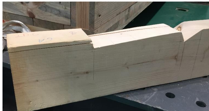
Figura 4.21 – Roturas do ensaio 5-D-C
