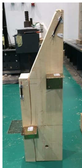
Figura 4.22 - Rotura da linha
