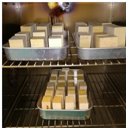
Figura 3.8 - Secagem das peças de madeiras para a obtenção do teor de água
