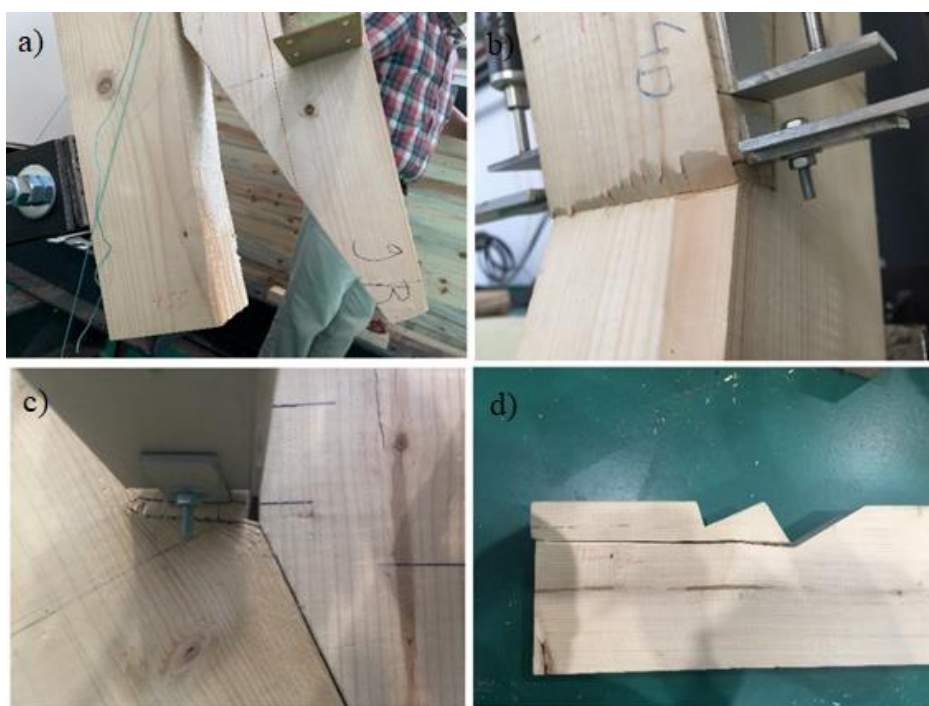
Figura 3.10 - Modos de rotura: a)Corte na Superfície Superior b)Compressão no Dente (Anterior) c)Compressão no Dente (Posterior) d)Corte na Superfície Inferior
