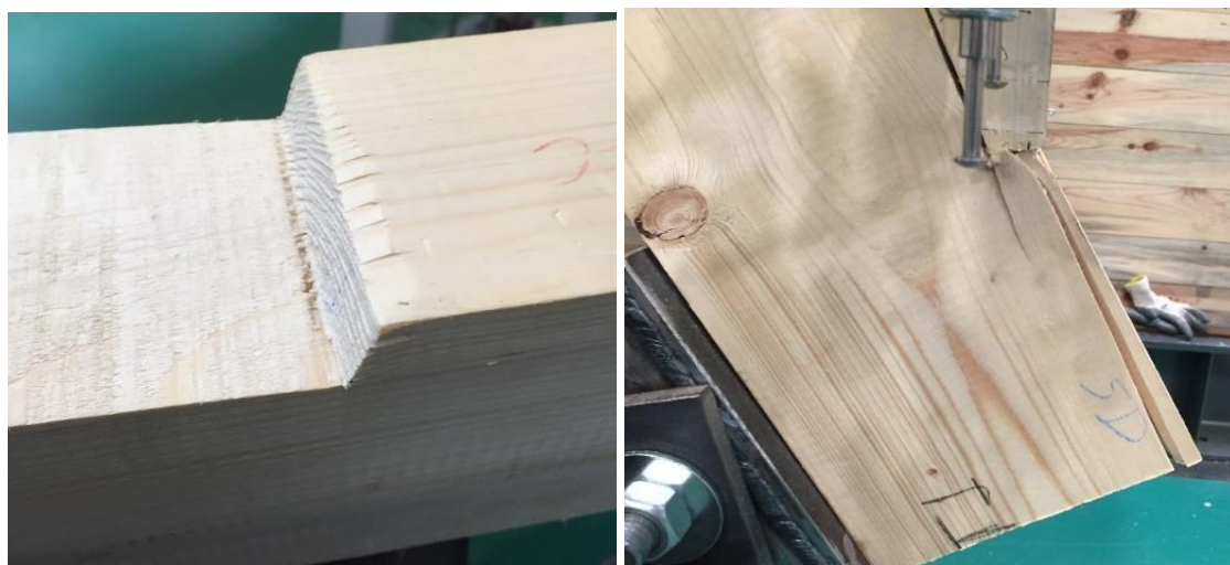
Figura 4.19 – Rotura dos ensaios 1-D-C e 2-D-C
