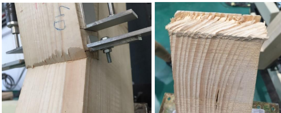
Figura 4.5 - Esmagamento na perna dos provetes 1-SA-C e 2-SA-C, respectivamente
