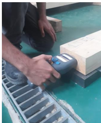
Figura 3.3 - Ensaio de módulo de elasticidade MTG
