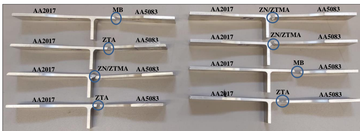
Figura 4.26. Zonas de fratura dos provetes de fadiga da série 6_265PCR-60.
