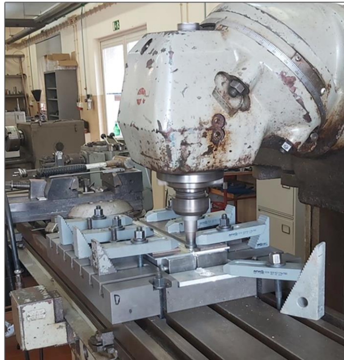
Figura 3.3. Disposição do sistema de fixação das chapas para a soldadura SFL (autoria própria).
