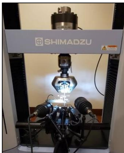
Figura 3.9. Ensaio de tração aplicado aos provetes, com uso do sistema de extensometria óptica.
