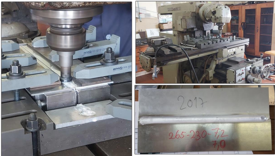
Figura 3.5. Execução da SFL pela fresadora e o aspeto superficial da junta T-Butt soldada (autoria própria).
