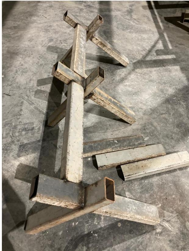
**Figura 37 - Cavalete de suporte para a peça das cintas, roldana e pinça**
