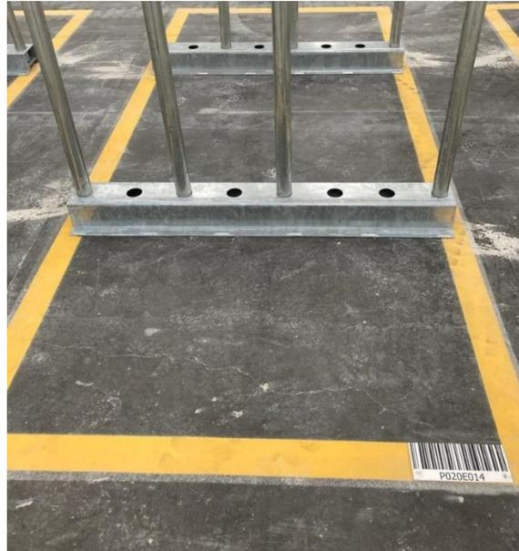
**Figura 26 - Identificação das células com códigos de barras**
