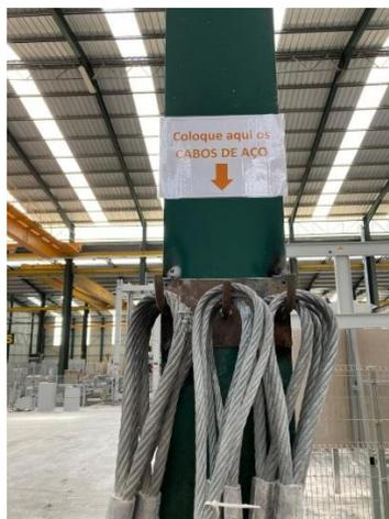
**Figura 33 - Cabides para suporte de cabos de aço produzidos pela secção de serralharia e instalados em cada um dos pavilhões**
