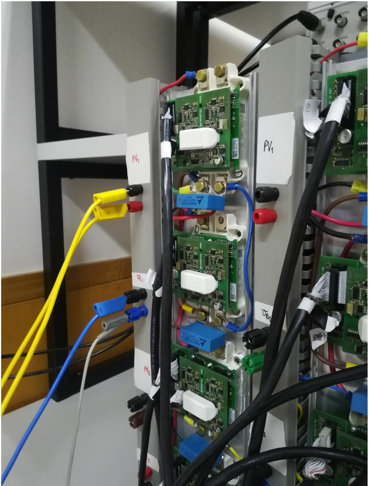
**Figura A.19:** IGBT's e díodos.
