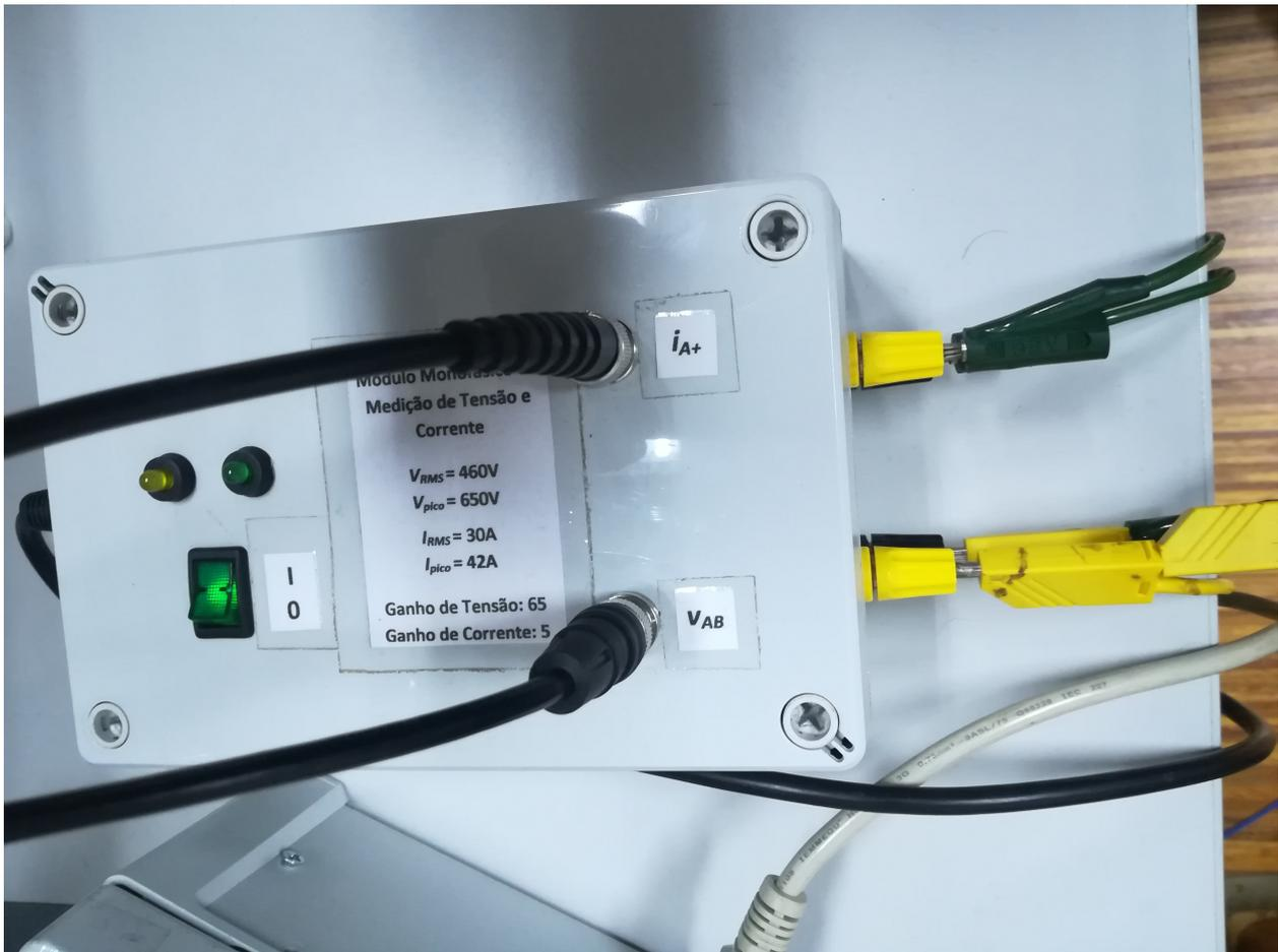
Figura A.22: Sensor de tensão e corrente da saída.
