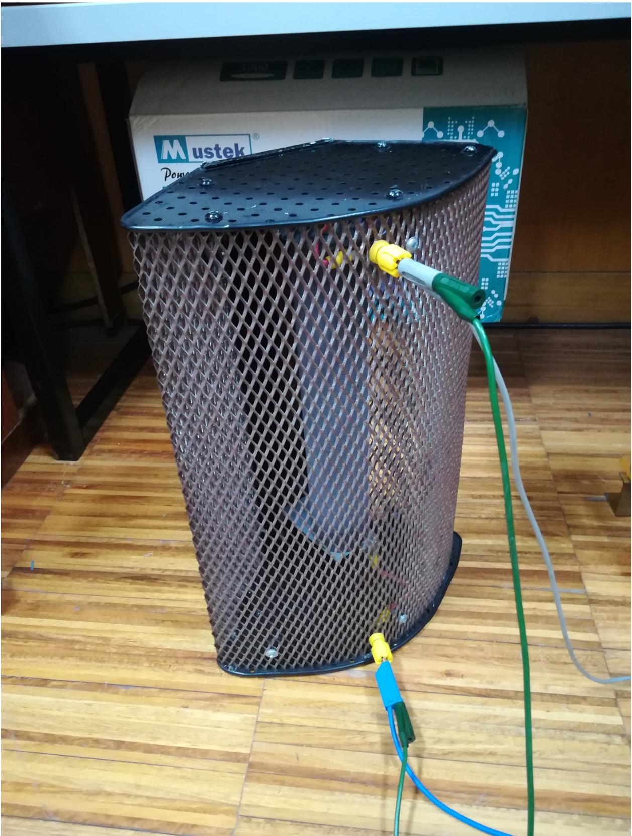
**Figura A.18:** Resistência de arranque de  $100\Omega$ .
