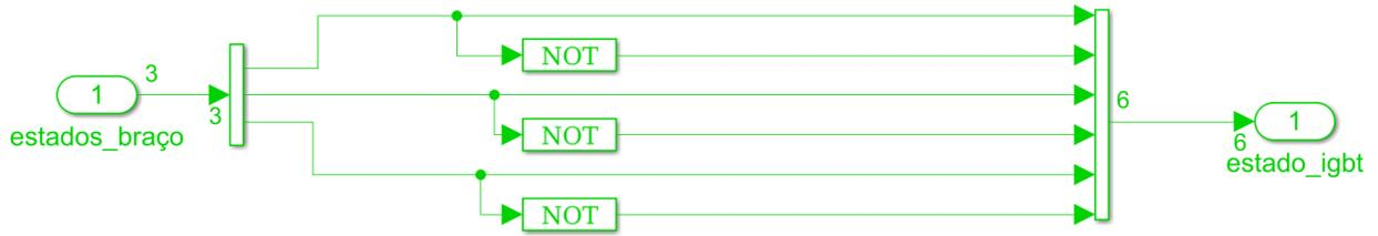
Figura A.32: Transição dos estados dos braços do retificador para o estado do IGBT.
