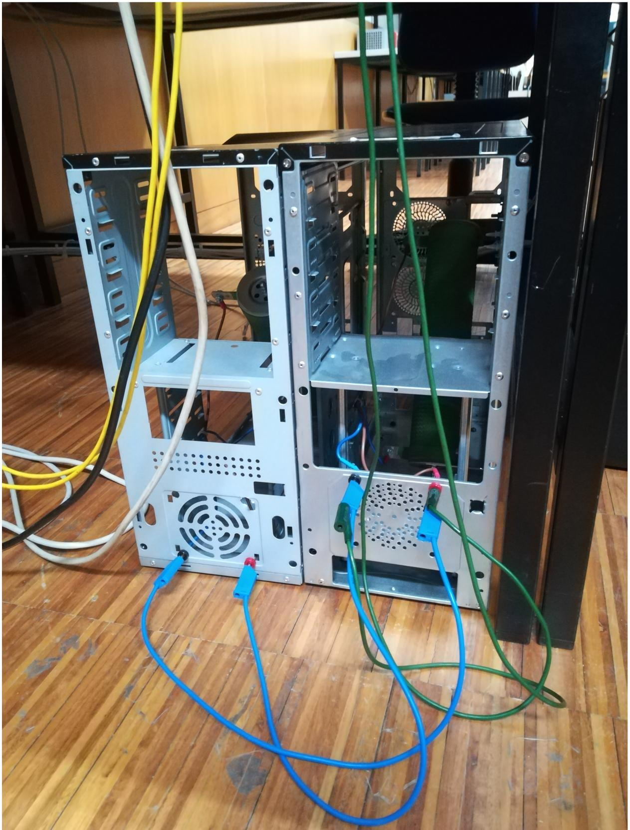
**Figura A.23:** *Carga com duas resistências de  $100\Omega$  em paralelo.*
