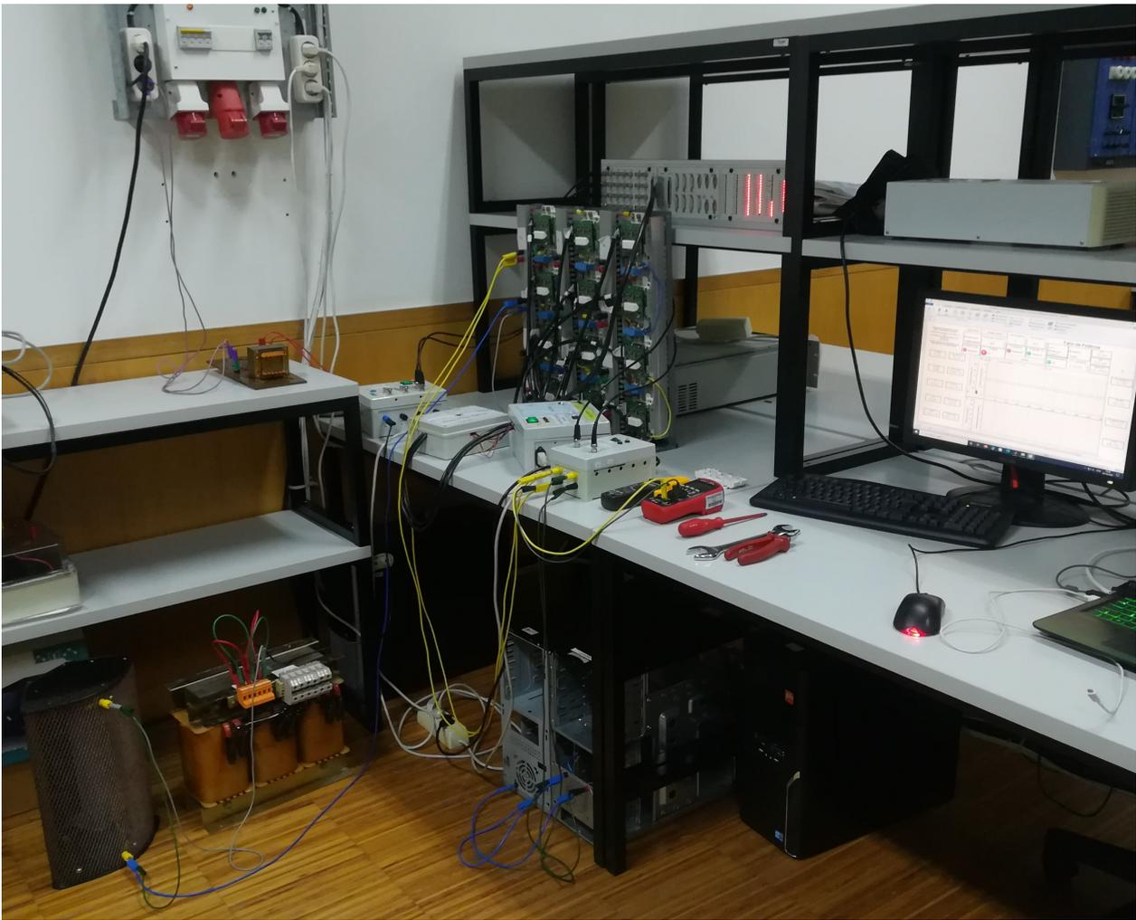
**Figura 4.1:** Montagem da experiência laboratorial do retificador monofásico controlado.
