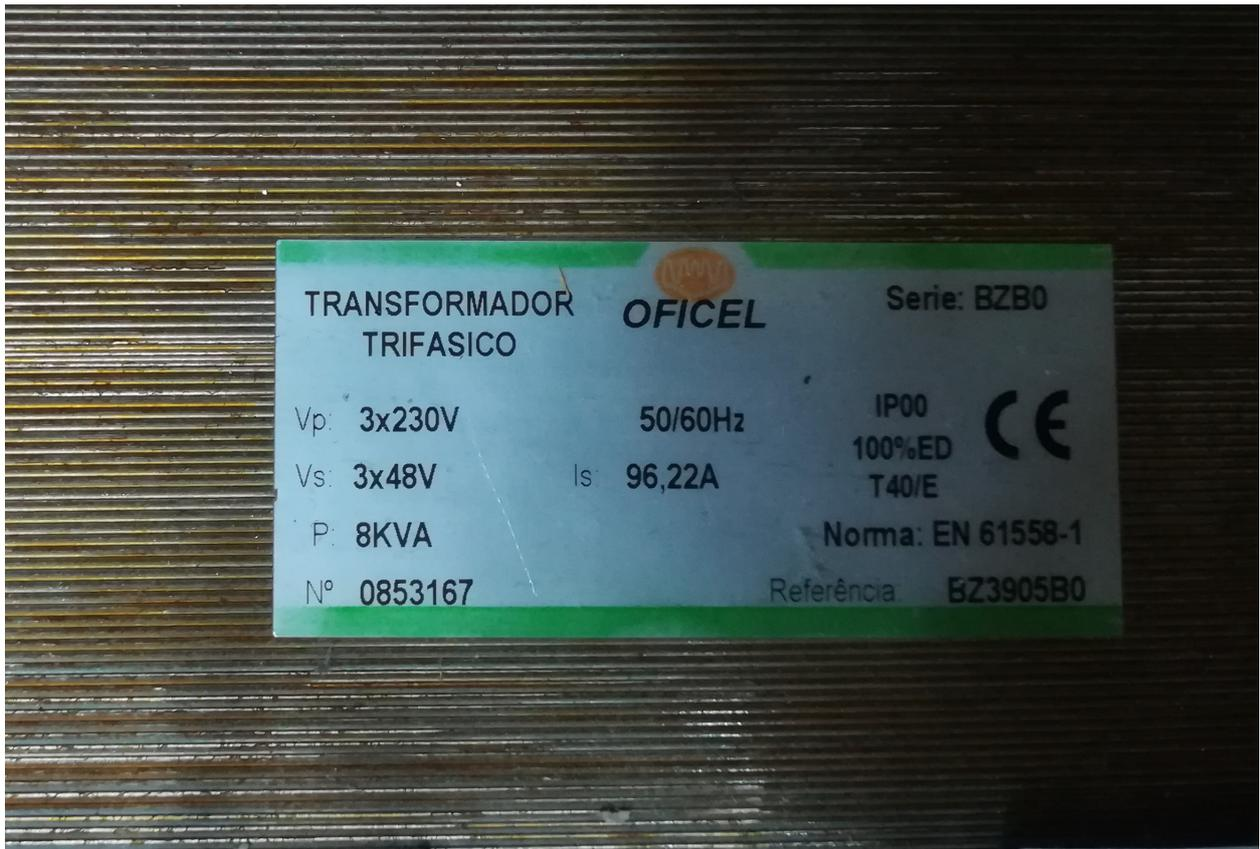
**Figura A.17:** Chapa de características do transformador trifásico usado para servir de bobina de filtro.
