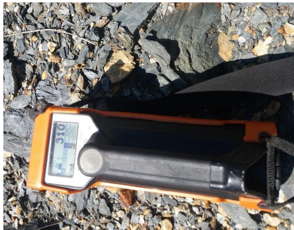
Figura 4.5 - Espectrómetro portátil RS-230 super-SPEC utilizado nos trabalhos radiométricos de campo.
