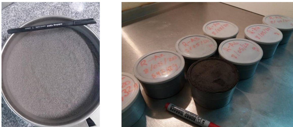
Figura 4.8 - Crivagem das amostras e respetivo enchimento dos recipientes para posterior análise no espectrómetro de bancada.
