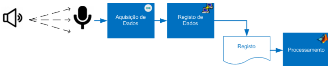
Figura 2.14: Diagrama de blocos da plataforma de aquisição de dados
