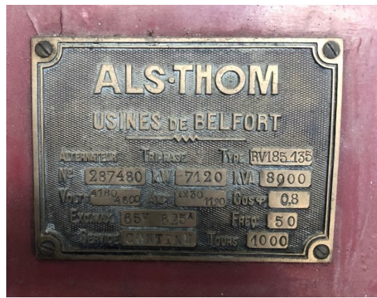
(a) (b) Figura C.14 – Gerador Alsthom da central de Vila Cova. (a) Vista geral (b) Pormenor da chapa de características, 8900kVA.
