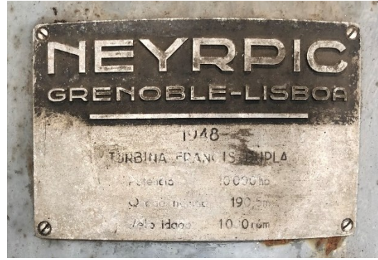
(a) (b) Figura C.13 – Turbina Neyrpic , 1948 da central de Vila Cova. (a) Vista geral (b) Pormenor da chapa de características.
