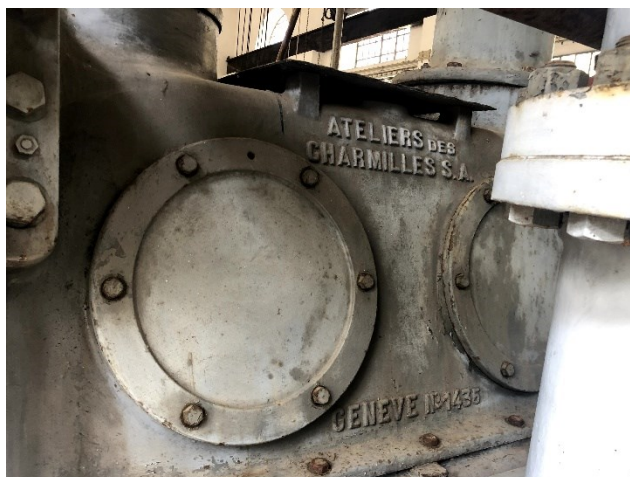
Figura C.11 – Pormenor da inscrição do número e do fabricante da turbina Charmilles (dupla)
