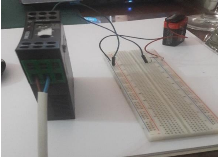
Figura 59 - Circuito eletrónico montado para teste dos transdutores suspeitos de estarem danificados
