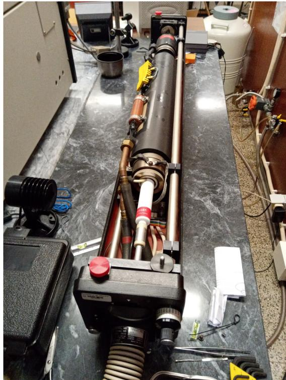
Figura E.3: Laser Innova Coherent 90 com a cobertura retirada para alinhamento.
