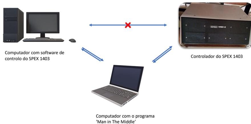
Figura 3.1: Representação da ligação entre os dispositivos de modo a executar a interferência 'Man in The Middle'. Quebrou-se a ligação física entre o computador, com o software de controlo do SPEX 1403, e o controlador do SPEX 1403 e foi introduzido um computador, onde é executado o programa 'Man in The Middle', entre estes.
