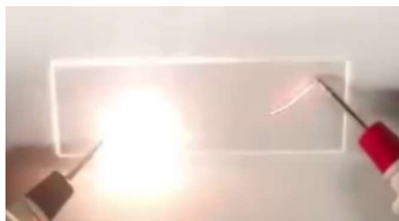
Figura 3.25 – Ignição do filme Ni/Al_N_0,05_25_S pelo modo II.
