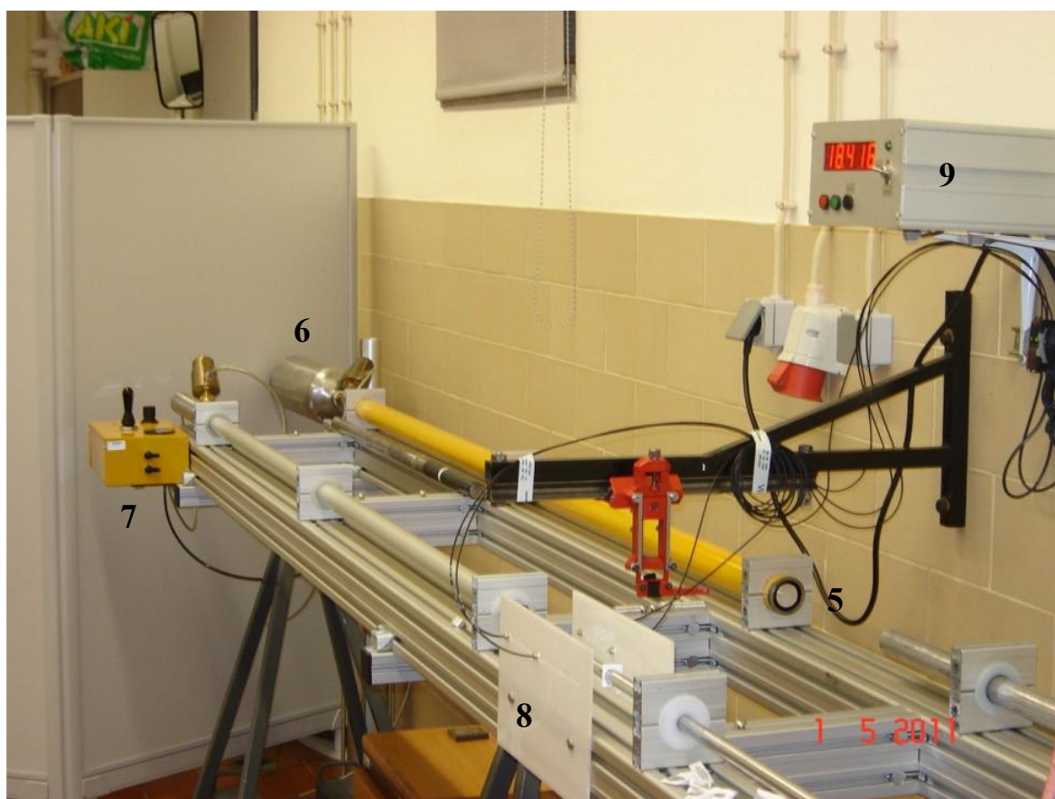
Figura 3.6. Projétil (5 e 6), caixa de comando (7), velocímetro (8 e 9)
