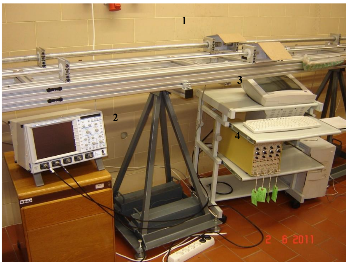
Figura 3.5. sistemas de Barras de Hopkinson e respetivo equipamento eletrónico
