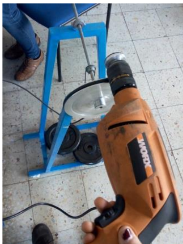
Figura 9 – Berbequim colocado em funcionamento no contorno do disco.
