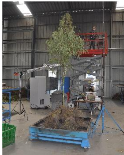
Figura 12 – (a) Câmara ótica do PIV, (b) Amostra colocada na mesa de combustão
