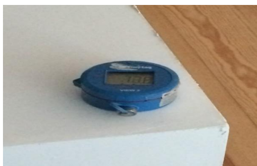
Figura 5.1 - Termohigrómetro colocado no interior da moradia.
