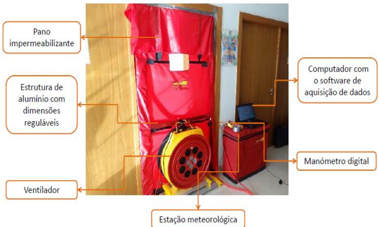
Figura 2.11- Legenda do ensaio com porta ventiladora (blower door test) (Gonçalves, M. 2015).
