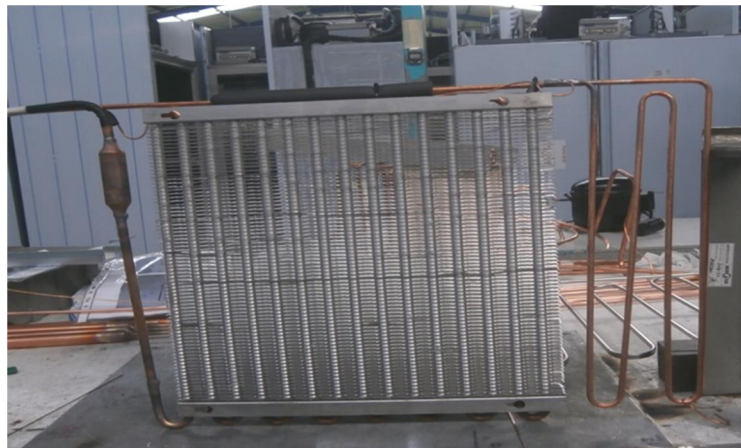
Figura 37 - Operações de soldadura no evaporador
