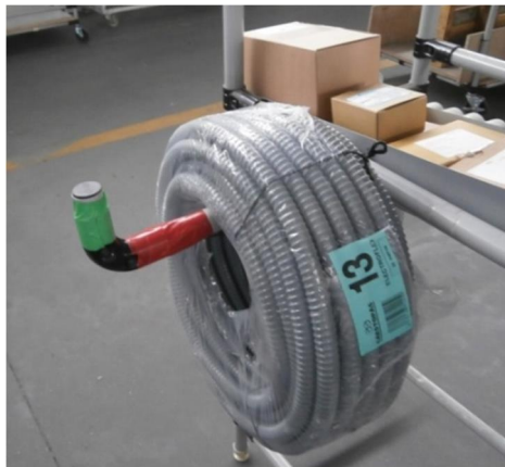
Figura 41 - Abastecimento de material por gestão visual
