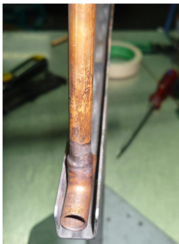
Figura 19 - Gabarit para soldadura do "T"
