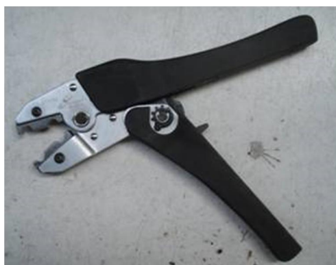
Figura 39 - Alicate especial para realizar o aperto dos tubos
