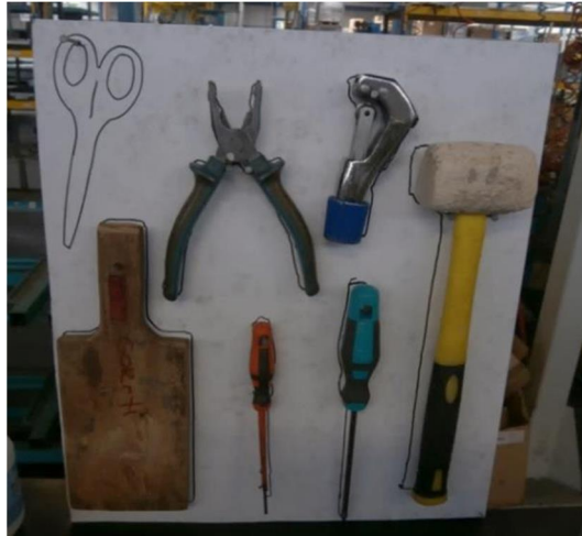
Figura 44 - Quadro sombra do posto de trabalho 3
