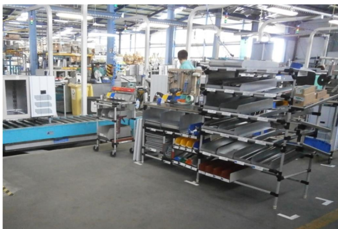
Figura 42 - Abastecimento realizado pela lateral do posto de trabalho
