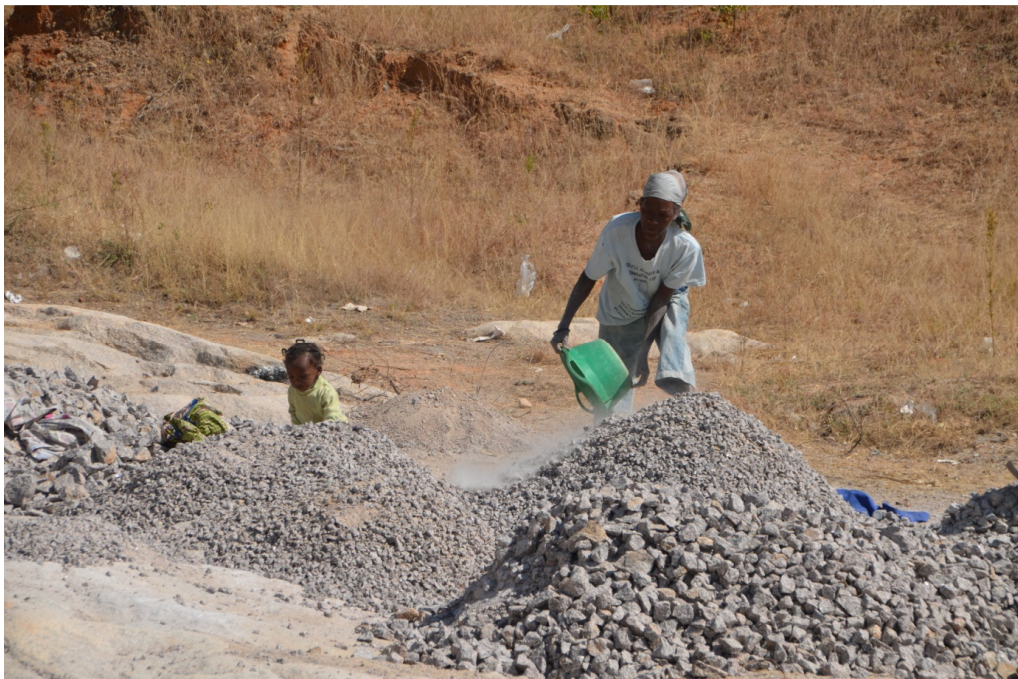
Figura 2.9 - Exploração artesanal de inertes (brita) na pedreira.
