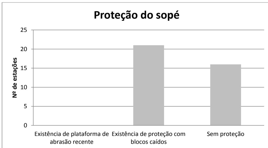
Figura 5.17 - Distribuição da proteção de sopé das arribas.
