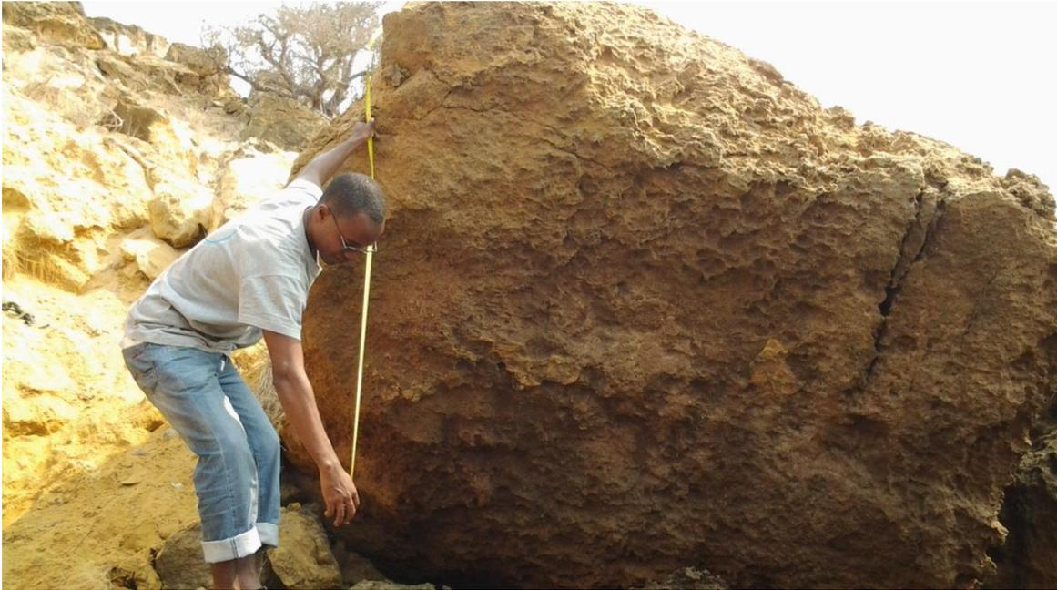
Figura 5.24 – Ilustração do método de medição do volume da instabilidade.
